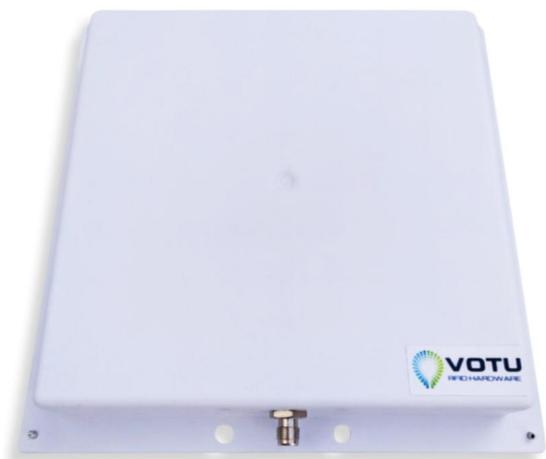
A VRA-8502 é uma antena de campo distante feita para sistemas RFID UHF, possuindo polarização circular com baixa razão axial, e apresentando ganho elevado e largo feixe de 3 dB.
