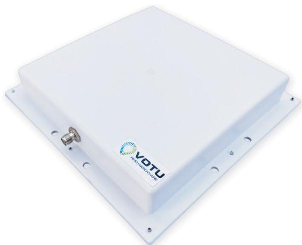
Com campo próximo elétrico circular intenso e uniforme, a Antena VRA-8503 estabelece uma zona de leitura compacta, muito bem definida e com baixa sensibilidade à orientação das *tags*. Leituras indesejadas resultantes da reflexão de energia eletromagnética propagada não acontecem na Antena VRA-8503, pois apresentam baixo ganho em campo distante.
